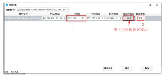
完成后点击确定,可以在工程栏出现 AIOBOX-MT222F。
