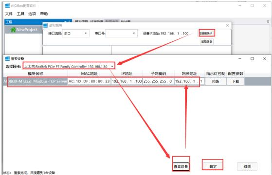
4、当网络结构存在多个模块时,可以在扫描界面弹出多个设备,可以直接 在这个界面修改 IP 地址,通过点击闪烁按钮定位现场实际的模块。
