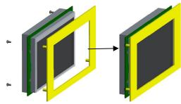
本产品采取后安装形式。产品四周预留 了4个∮3mm的安装孔,如左图所示, 将孔位与外壳螺纹柱孔对齐, 拧入 M3 规格的螺丝后固定。注意:产品正面触 控面板需要进行外部辅助加固,以防长 时间或复杂环境下脱落!
